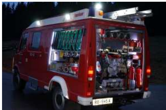
Neue LED-Beleuchtung für Außen und für den Geräteraum des Kleinlöschfahrzeuges.
